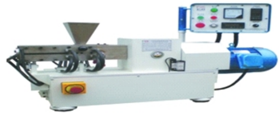
ماكينة الغزل الانصهاري تستخدم في الصهر الحراري للبوليمرات (خرز او قشور)
