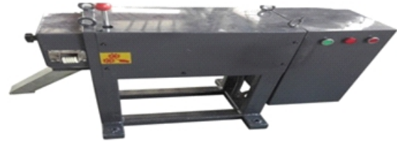
ماكينة تستخدم في تحويل البوليمر إلى حبيبات
